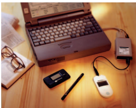
С помощью специального устройства сенсорные глюкометры можно подсоединять к персональному компьютеру. Они могут быть выполнены в виде ручки или пейджера, как представленные глюкометры MediSens Card и Pen
